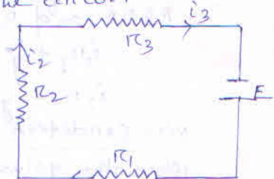
$$i_1 R_1 + i_2 R_2 + i_3 R_3 = 0$$
